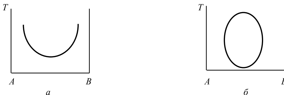
Рис. 13. Диаграммы температура – состав для двух жидкостей с ограниченной взаимной растворимостью: a – система имеет нижнюю критическую температуру растворения; b – система имеет две критические температуры растворения
