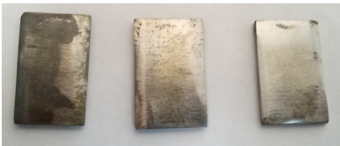
Рис. 4 Внешний вид образцов после удаления продуктов коррозии, слева направо: холостой опыт, G-425, Астос 46-45; опыт в хозяйственно-питьевой воде
