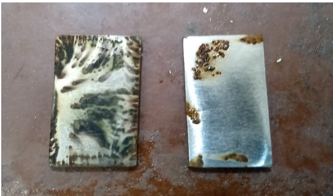
Рис. 3 Внешний вид стальных образцов после коррозии в хозяйственно-питьевой воде в присутствии смазки G-425 (слева) и Астос 46-45 (справа)
