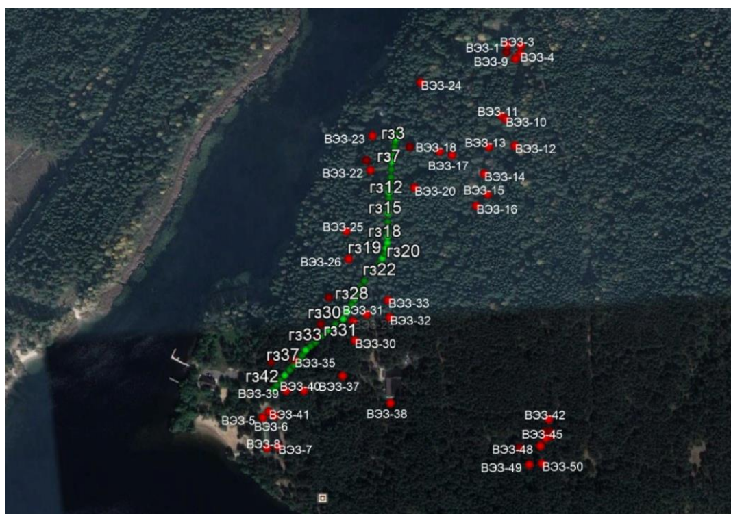
Рис. 1. Схема расположения точек ВЭЗ и профиля ГЗ
