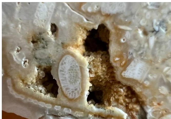
Рис. 4. Отложения халцедона в полостях порового пространства рифового фузулинового известняка
