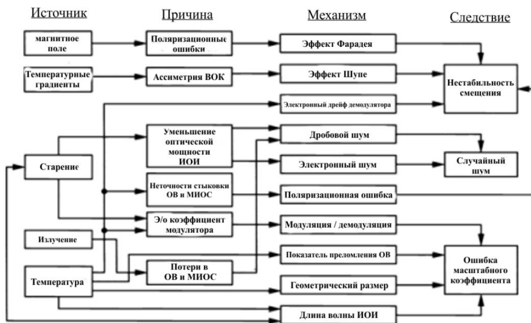
Рис. 2. Возникновение ошибок в выходном сигнале ВОГ под действием различных факторов
