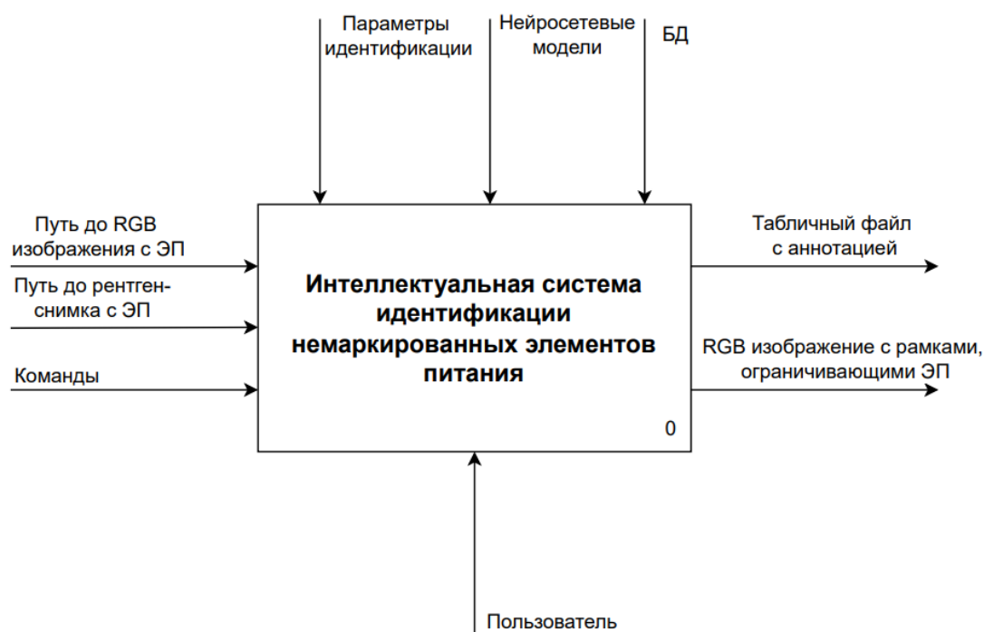
Рисунок 1. Контекстная диаграмма А-0 «Интеллектуальная система идентификации немаркированных элементов питания»
