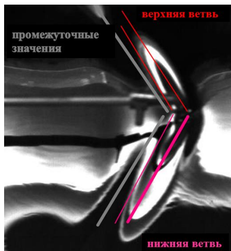
Рис. 3. Схема определения углов наклона волновых валов, возникающих на поверхности магнитной жидкости около движущегося препятствия
