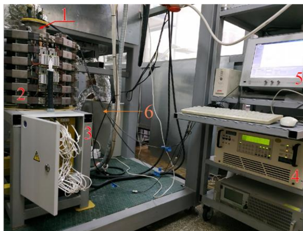
Рис. 1. Фото экспериментальной установки: 1 – канал кристаллизатора, 2 – индукционный перемешиватель, 3 – система коммутации перемешивателя, 4 – источник питания, 5 – УДА, 6 – система термостатирования
