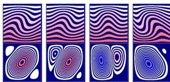
Рис. 6. Фрагмент из видеоряда эволюции поля скорости в ходе перестройки при значении числа Грасгофа Gr = 17890 ( r = 2.5 ) и угла наклона 7.75 градусов
