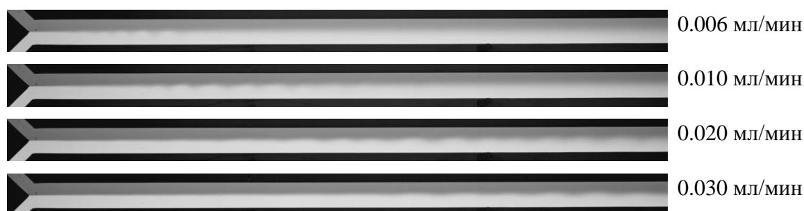
Рис. 2. Серия изображений, характеризующая развитие конвекции диффузионного слоя в эксперименте №1 при различных расходах. Высота канала d = 0.25 \text{ см}
