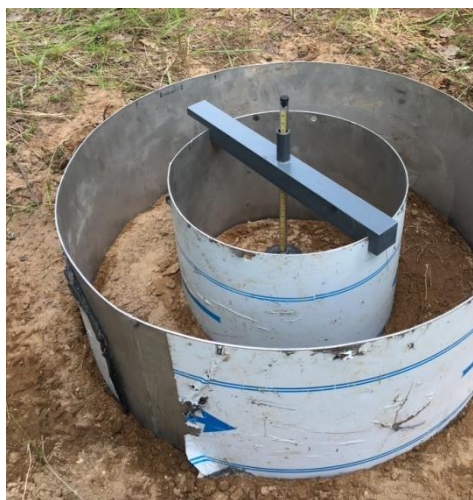
Рисунок 4.22 – Определение фильтрационных характеристик грунтов на полигоне
