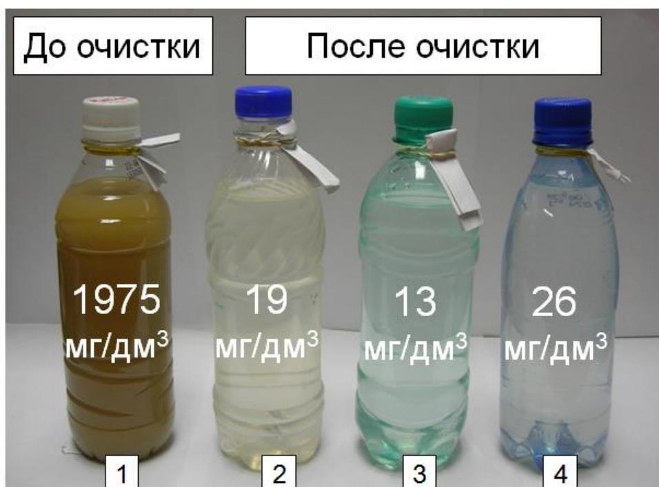
Рисунок 2.9 – Концентрации взвешенных веществ в водах до и после очистки в фильтрационном поле: 1 – на сливе из дренажного водоема; 2–4 – из отводящих водоемов
