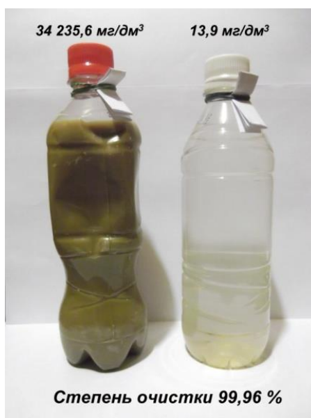
Рисунок 2.11 – Степень очистки воды, достигнутая в фильтрационном поле, из отложений гидроотвала обогатительной установки
