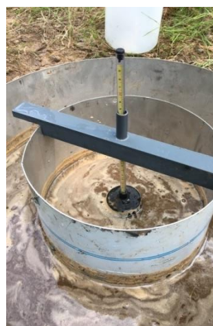
Рисунок 4.22 – Определение фильтрационных характеристик грунтов на полигоне
