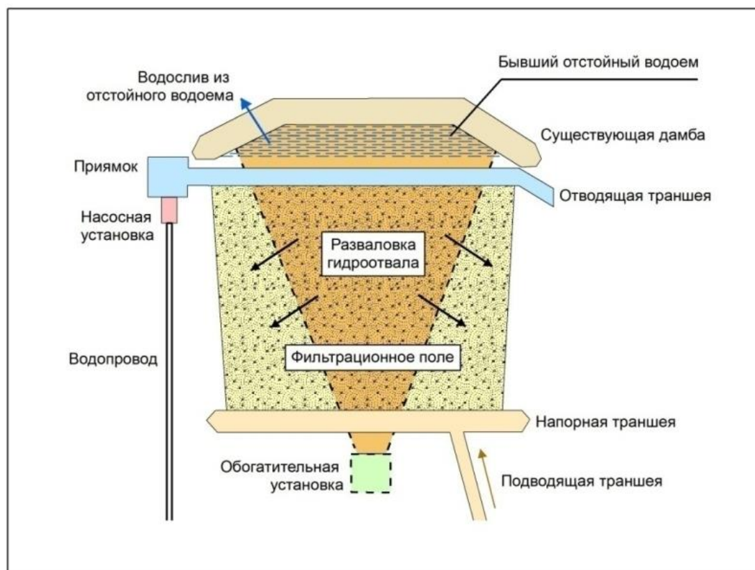
Рисунок 2.12 – Схема системы очистки оборотной воды
