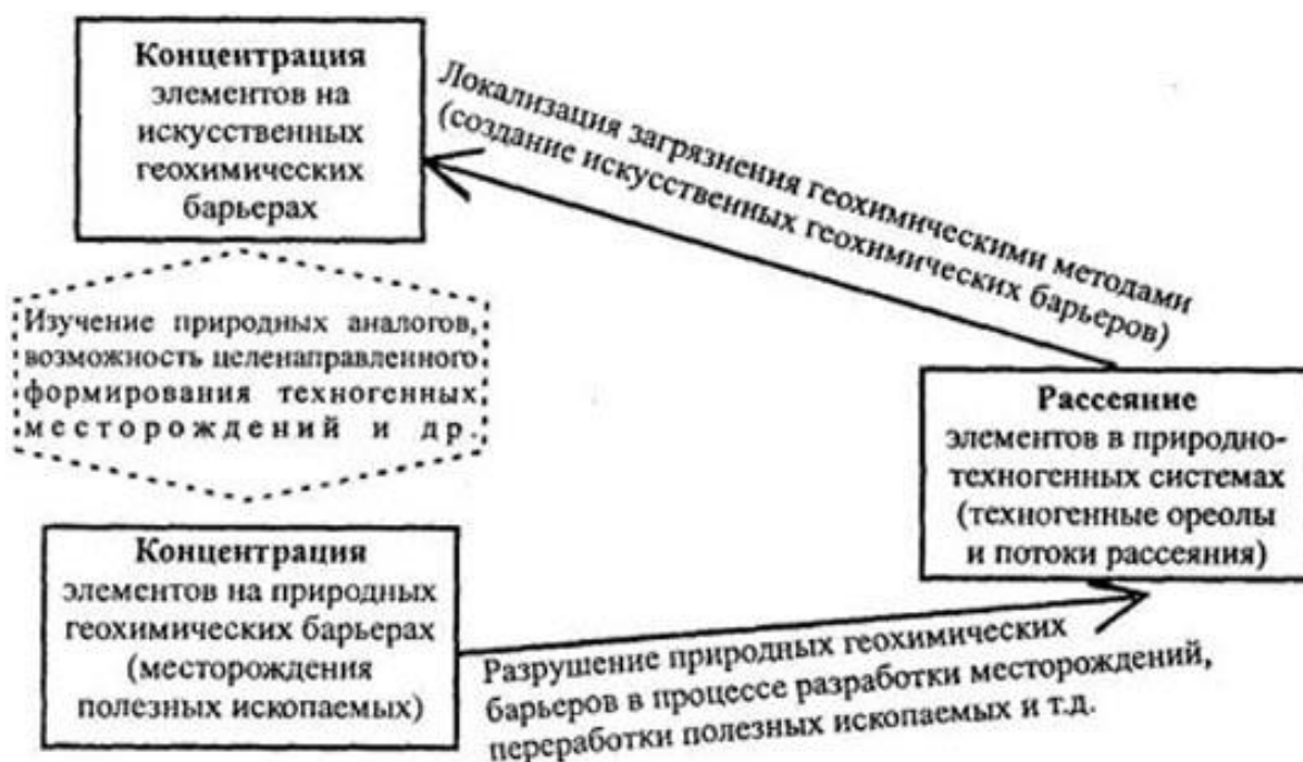
Рисунок 4.1 – Схема создания искусственных геохимических барьеров для охраны окружающей среды (на примере разработки месторождений полезных ископаемых)
