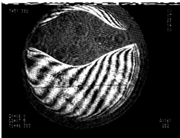
Рис. 19. Область оптической неоднородности через 23 с после теплового импульса при T - T_c = 5 \text{ K}
