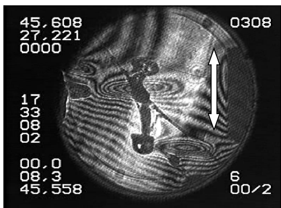
Рис. 34. Распространение теневой области при низкочастотном режиме воздействия (стрелками указано направление качаний)
