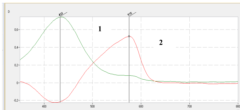
Рис. 69. Спектры поглощения КО (1) и его комплекса с ионами Pb^{2+} (2); \lambda_{\text{макс}}(\text{КО}) = 433 \text{ нм} ; \lambda_{\text{макс}}(\text{КС КО-Pb}) = 575 \text{ нм}
