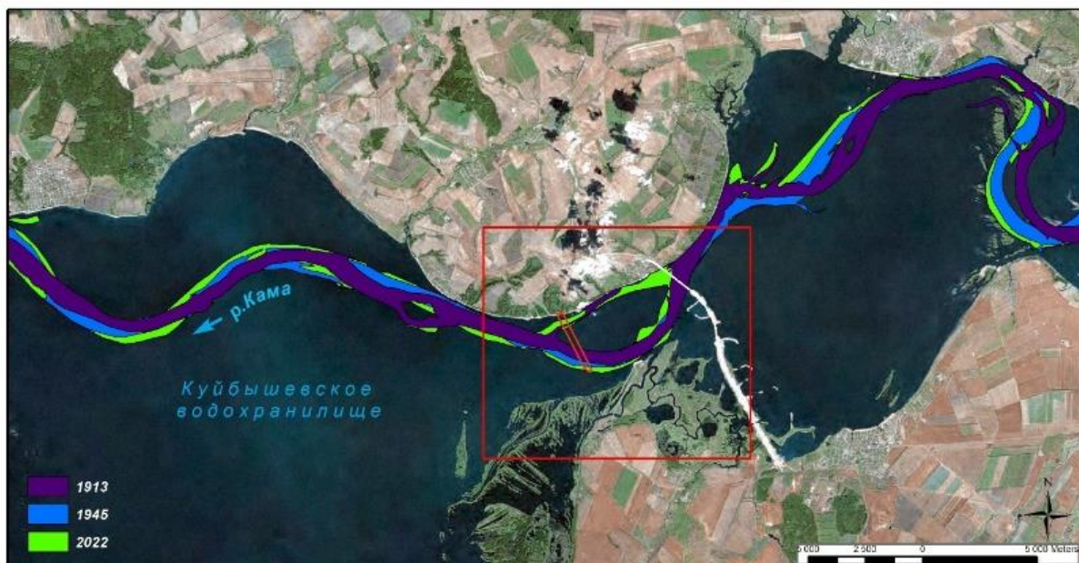
Рис.2. Схема горизонтальных деформаций русла Камы с 1913 г. по настоящее время
