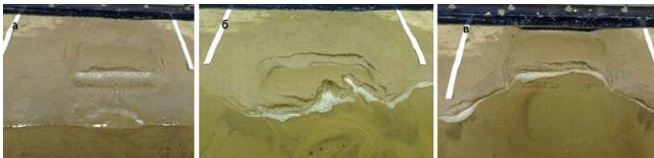
Рис.3. Вид береговых склонов с ледяными пластинами через 1 час воздействия водного потока в случаях: а – прямого русла, б – русла с сужением, в – русла с расширением
