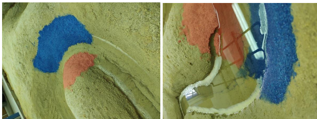
Рис. 3. Эксперименты по исследованию размыва меандра
