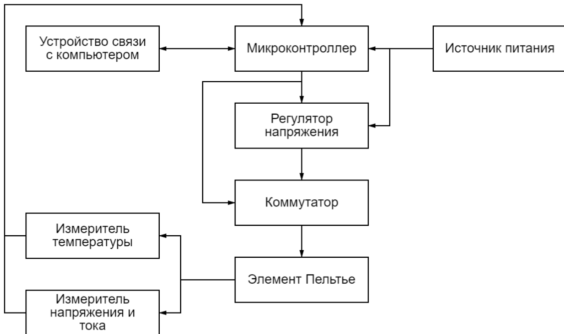
Рис. 2. Функциональная схема прибора
