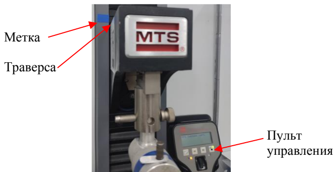
Рис. 3.16. Установка расстояния между валами разрывной машины E42
