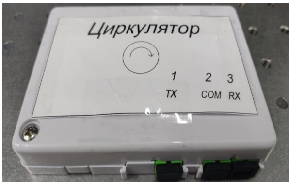
Рис. 2.27. Фотография корпусированного циркулятора с SC-адаптерами
