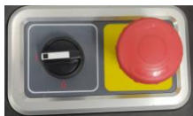
Рис. 3.14. Тумблер включено / выключено и кнопка аварийной остановки разрывной машины E42
