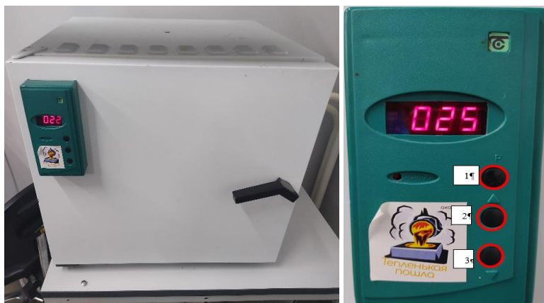
Рис. 4.2. Термокамера ШС-80-01: а – внешний вид; б – пульт управления. Кнопки управления термокамерой ШС-80-01: 1 – установки температуры; 2 – повышения температуры (▲); 3 – понижения температуры (▼)
