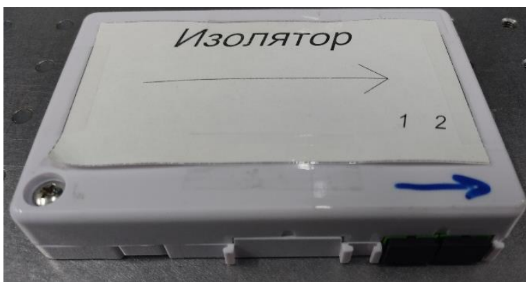
Рис. 2.24. Фотография корпусированного оптического изолятора
