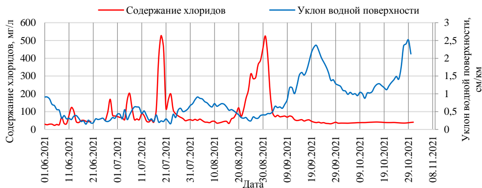
Рис. 3 Сопряженный хронологический график изменения содержания хлоридов на водозаборе АО «БСЗ» и уклона водной поверхности р. Кама между постами пгт Тюлькино и г. Березники за 2021 г.
