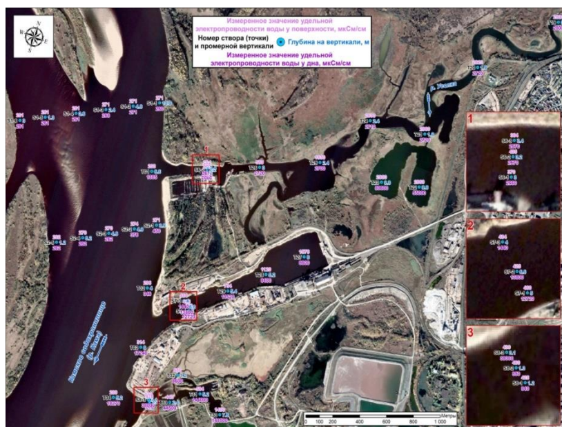
Рис. 1. Расположение вертикалей с измеренными значениями электропроводности(мкСм/см) (июль 2023)
