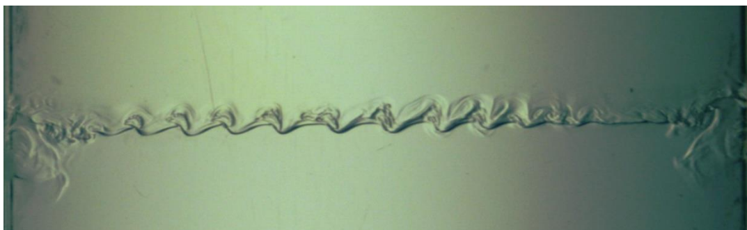
Рис. 2. Фотография рельефа при f = 13.0 \text{ Гц} , b = 0.74 \text{ см} , безразмерное время после включения вибраций (измеряемое в периодах колебаний) равно 191
