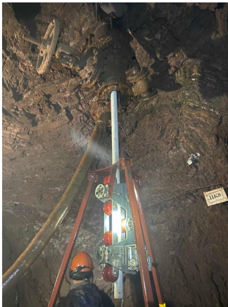
Рис. 2. Подача зонда в скважину
