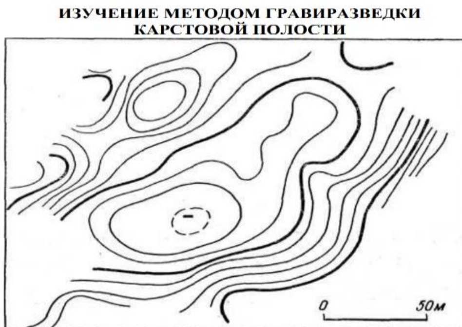
Гравитационная аномалия над карстовой полостью (по Г. Колли, 1963) Сечение изоаномал 0,1 мГл
