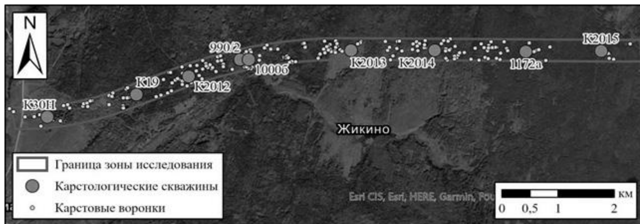
Рис. 4. Наиболее интенсивно закарстованный участок строящейся автомобильной дороги М-12 «Казань-Екатеринбург»
