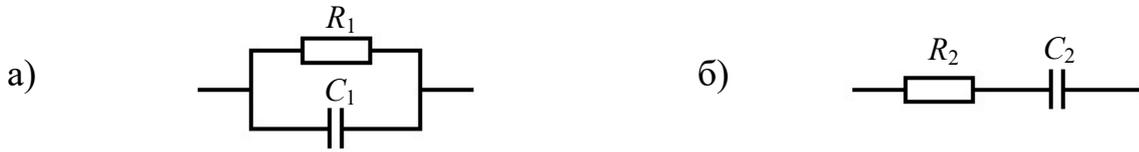
Рис. 7.1. Параллельная  $R_1C_1$ -цепь (а) и последовательная  $R_2C_2$ -цепь (б)
