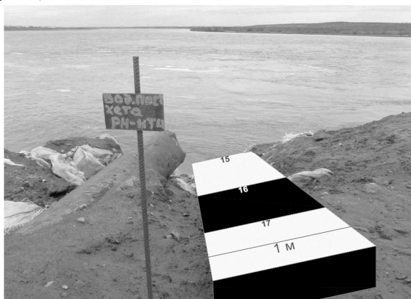
Рис. 1. Схема речного водомерного поста для дистанционных наблюдений
