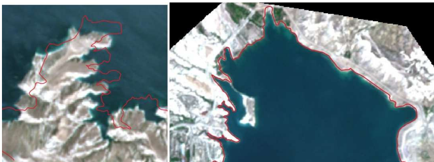
Демонстрация неудовлетворительного результата привязки топографического плана на снимке Sentinel-2, где красная линия – отвекторизованная по топоплану береговая линия (левый), финальный результат привязки топографического плана (правый)
