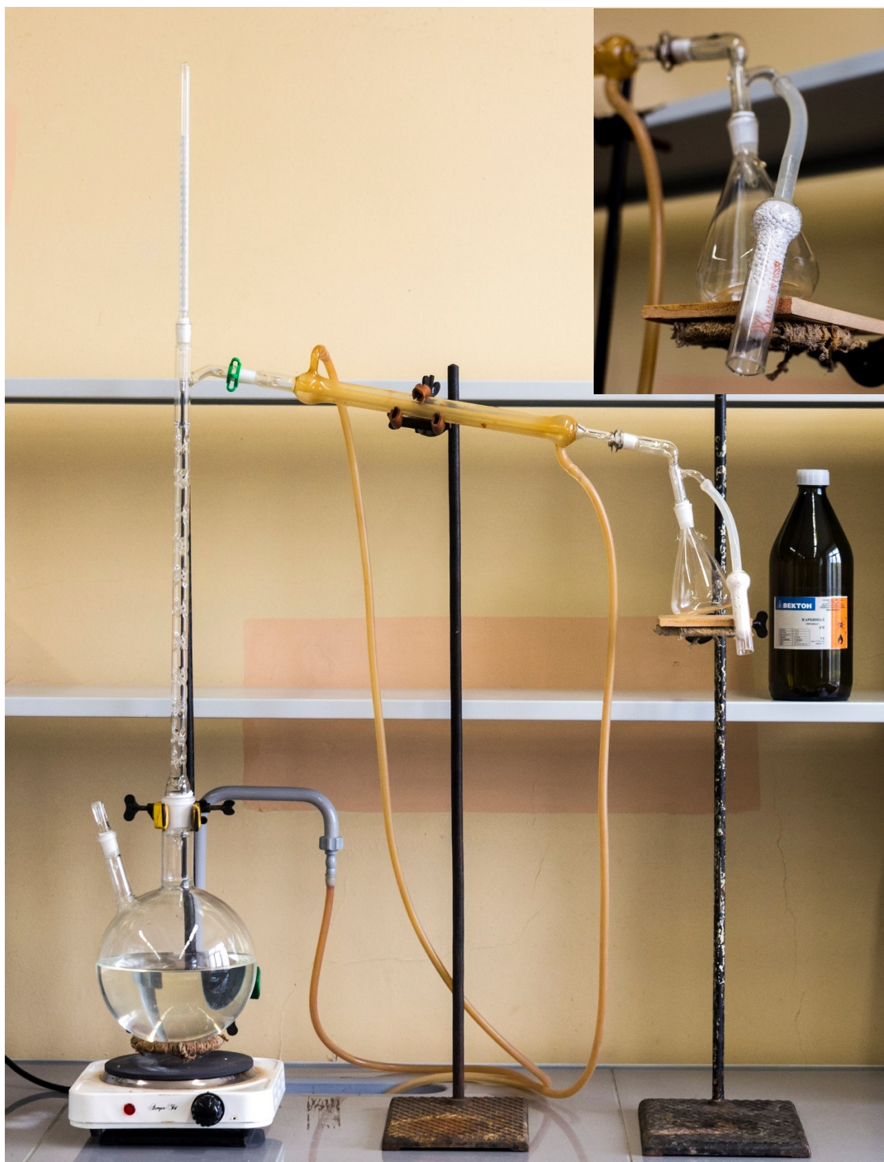
Рис. 17. Установка для перегонки метанола с дефлегматором
