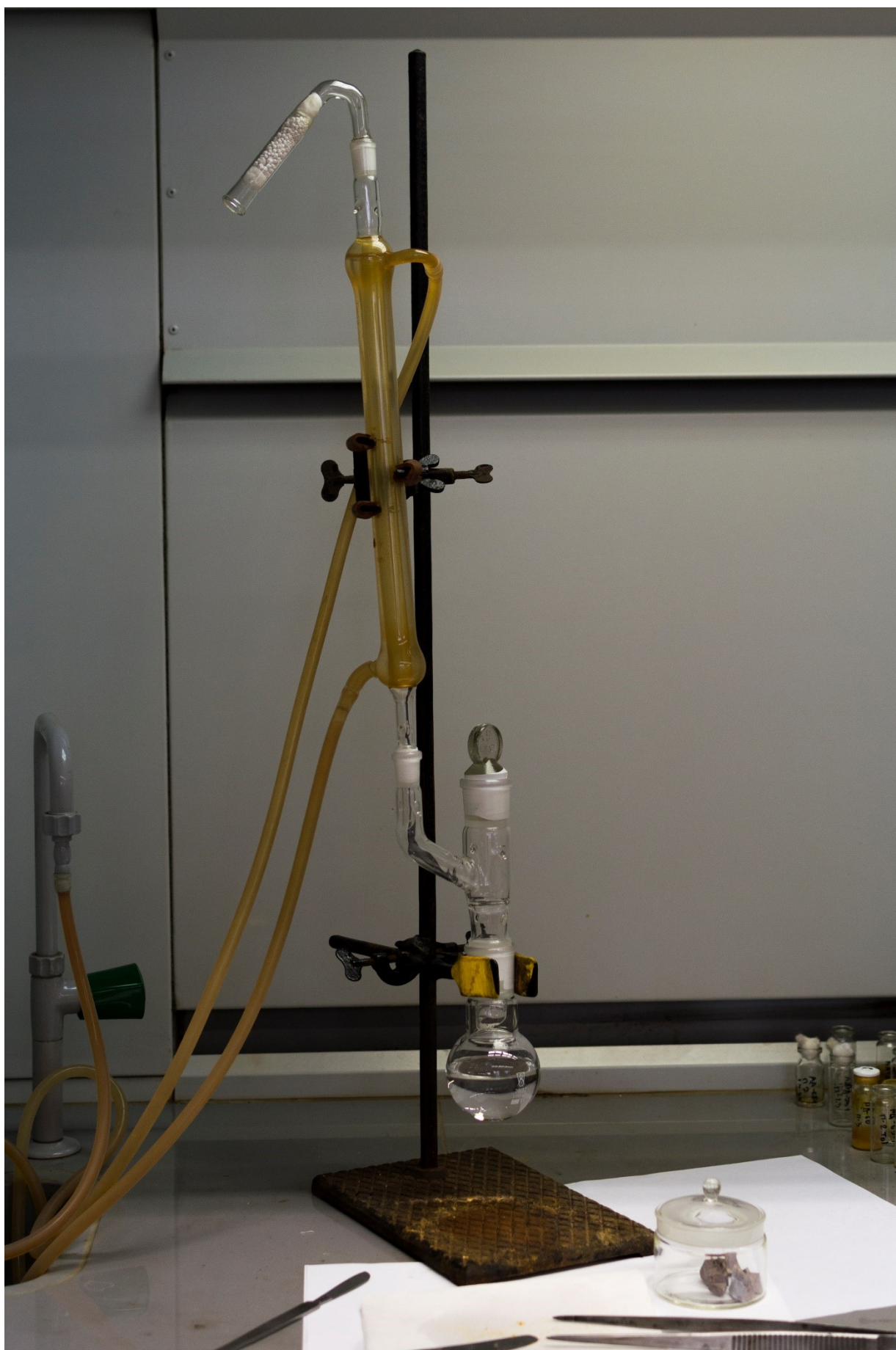
Рис. 18. Установка для приготовления метилата натрия (до начала растворения натрия)
