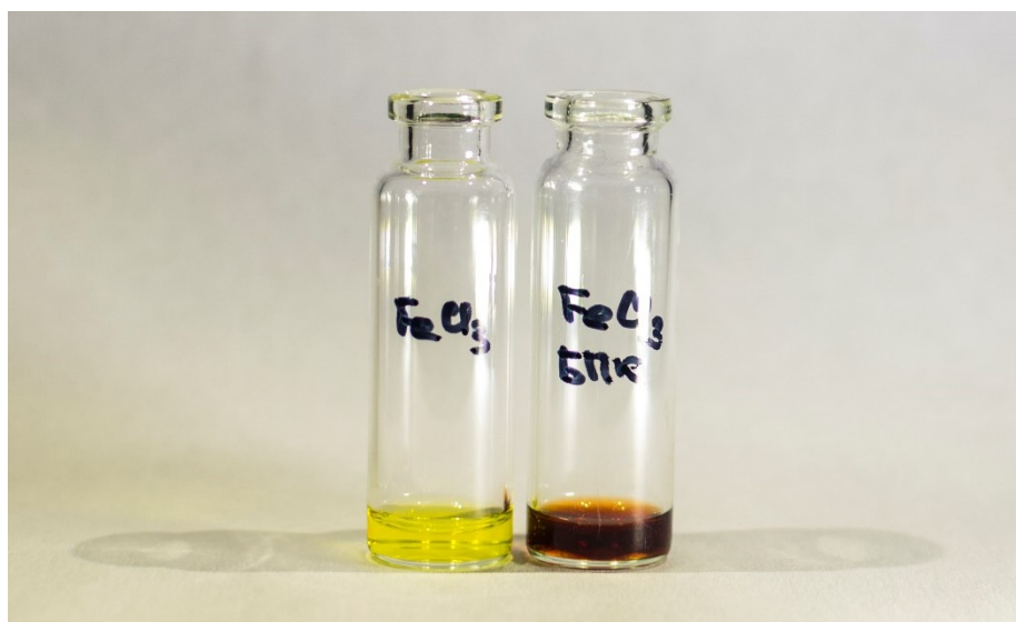
Рис. 127. Проба на енольный гидроксил: холостой опыт (слева) и БПК (справа)
