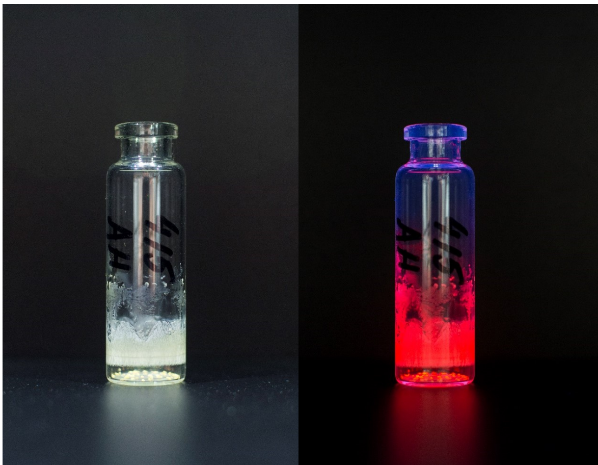
Рис. 128. Комплекс [\text{Eu}(\text{L})_3(\text{phen})] (в твердом состоянии) при видимом свете (слева) и при облучении УФ светом (365 нм) (справа)
