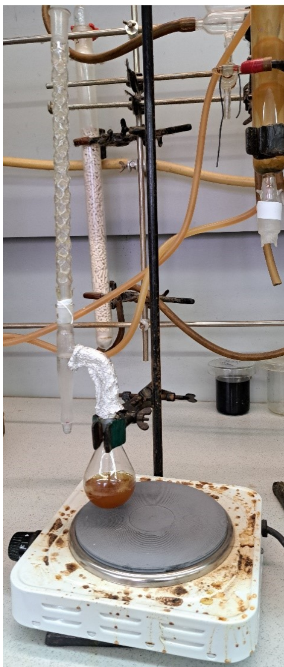
Рис. 4. Синтез анила p -бромацетофенона. Реакция проводится в ксилоле с использованием насадки Дина-Старка и добавлением ZnCl_2 [Salnikova, 2021]
