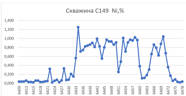
Рис. 9. График изменчивости содержаний никеля по скважине № 149
