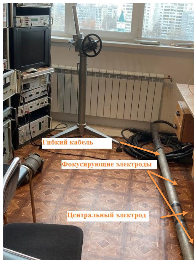
Рис.1. Прибор трехэлектродного бокового каротажа с гибким зондом
