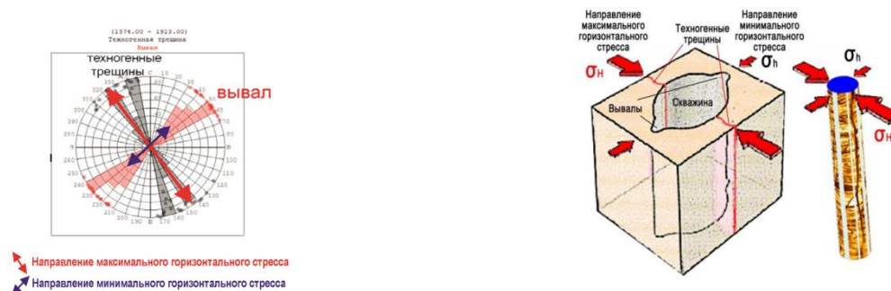
Рис 3. Стереограмма, направления вывалов и техногенных трещин по данным ЭМС, схема образования максимального и минимального напряжений горных пород
