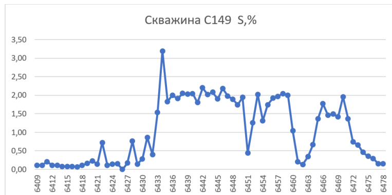
Рис. 12. График изменчивости содержаний серы по скважине № 149
