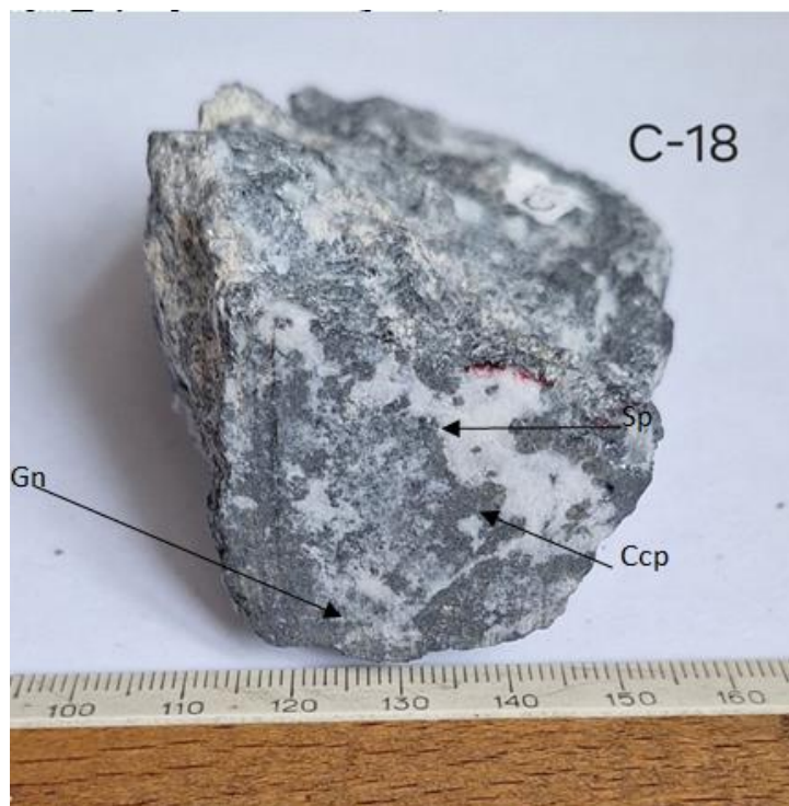
Рис. 4. Сульфидные руды вкрапленной текстуры. Минеральный состав руд: сфалерит, галенит, халькопирит с небольшим содержанием пирита. Образец C-18 Примечание. Csp – халькопирит, Gn – галенит, Sp – сфалерит.
