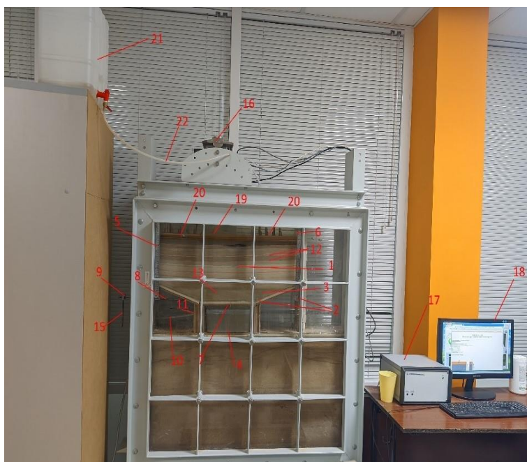
Рис. 1. Внешний вид устройства для определения суффозионной устойчивости грунтов.
