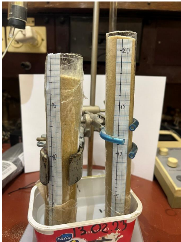
Рис. 1. Циклическое замачивание песка методом капиллярной пропитки
