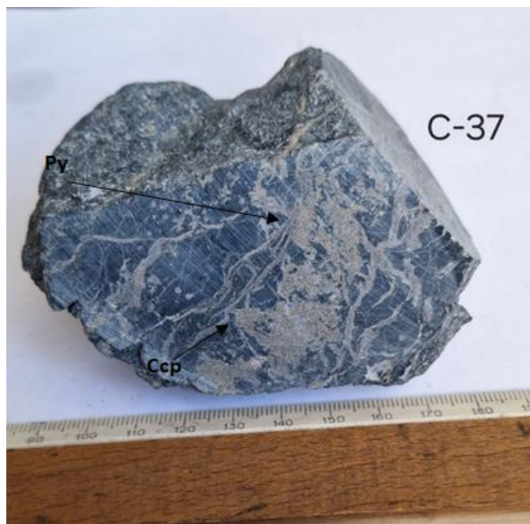
Рис. 5. Сульфидные руды прожилковой текстуры. Минеральный состав руд: халькопирит, пирит, с небольшим содержанием галенита и сфалерита. Образец C-37 Примечание. Csp – халькопирит, Py – пирит.
