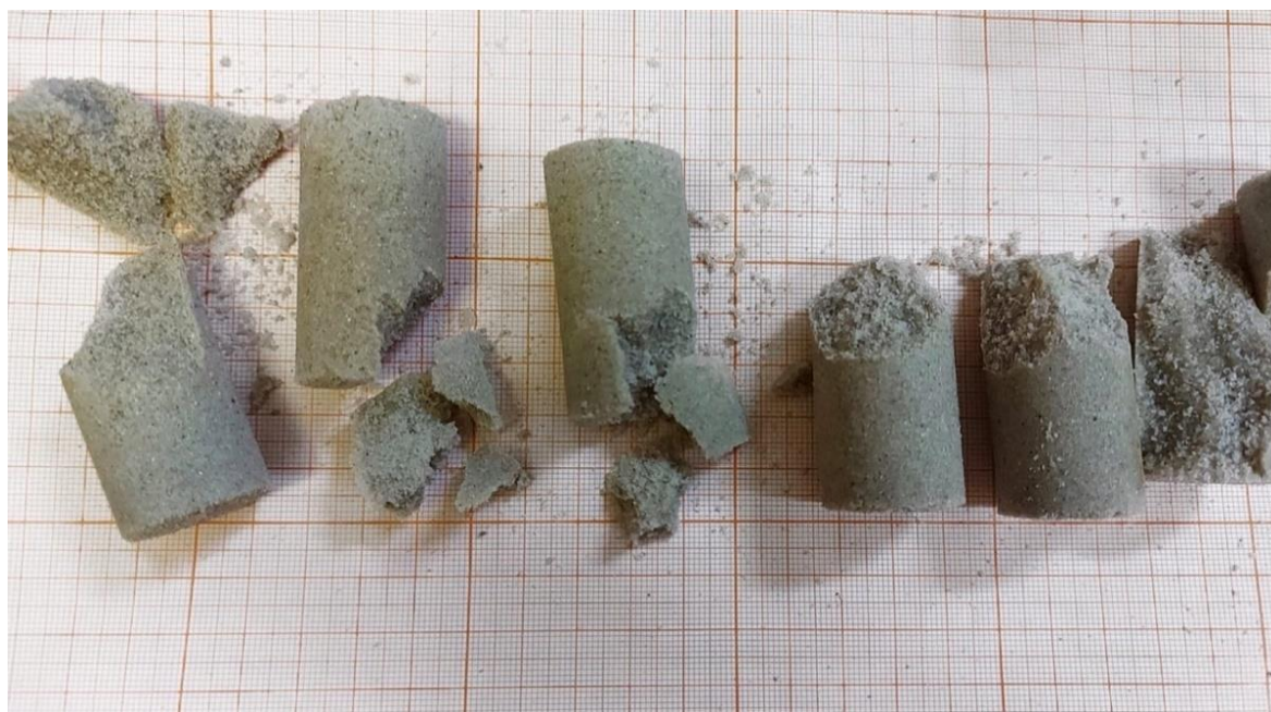
Рис. 2. Внешний вид закрепленных песчаных грунтов с карбонатными поверхностными пленками после испытаний на одноосное сжатие
