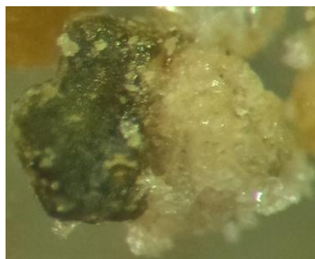
Рис. 5 – Кристаллизация соли NaCl на поверхности песчаных частиц (а) и на контактах между частицами (б)
