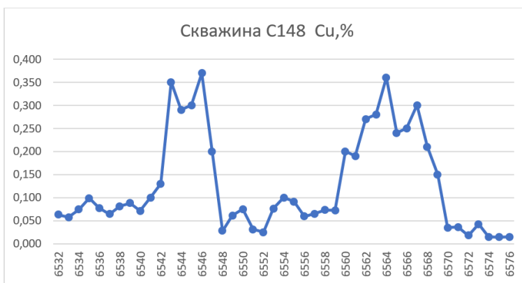
Рис. 6. График изменчивости содержаний меди по скважине № 148
