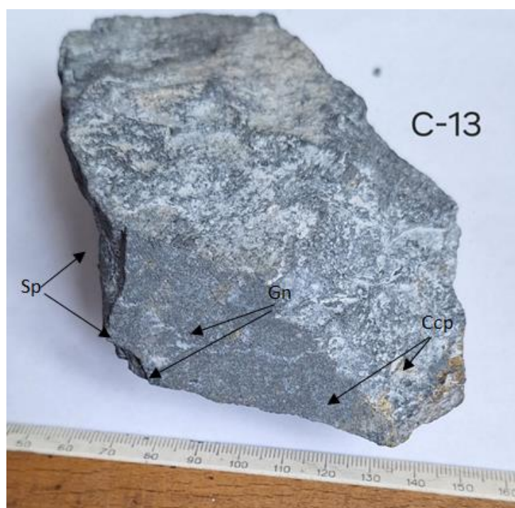
Рис. 3. Сульфидные руды сплошной текстуры. Минеральный состав руд: сфалерит, галенит, халькопирит с небольшим содержанием пирита Образец C-13. Примечание. Csp – халькопирит, Gn – галенит, Sp – сфалерит.
