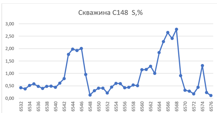
Рис. 8. График изменчивости содержаний серы по скважине № 148
