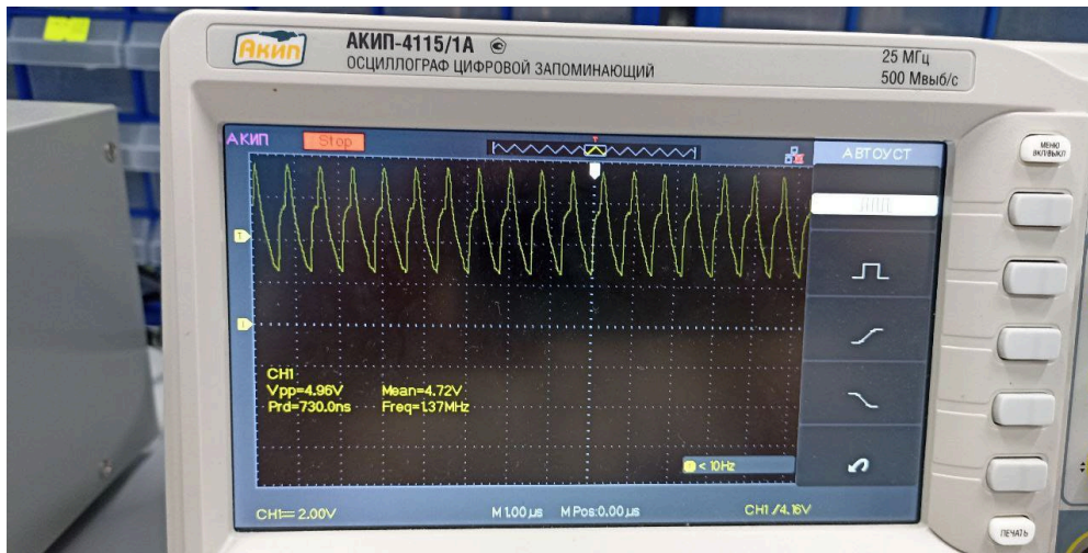
Рис. 4. Сигнал на обратной связи при значении тока 474 мА
