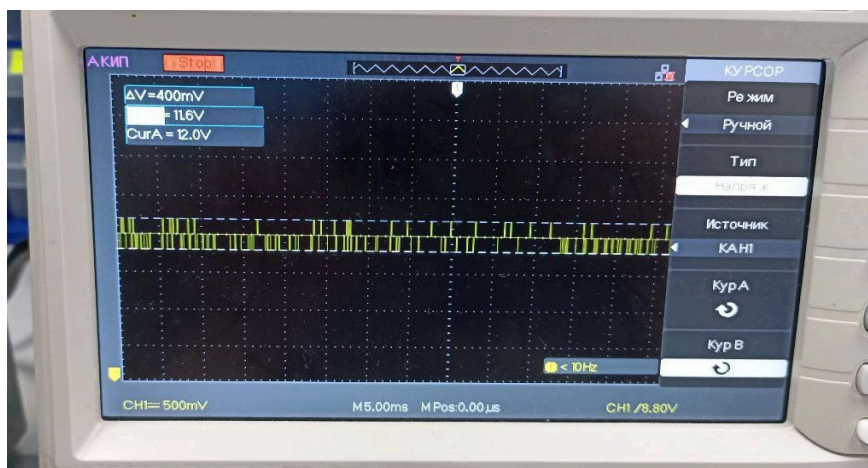
Рис. 6. Сигнал на выходе импульсного преобразователя после фильтра Баттерворта 4 порядка
