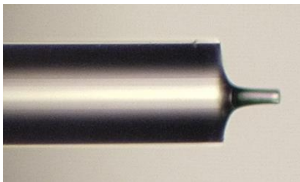
Рис. 2. Микрофотография датчика чувствительного элемента, сформированного из полимера основе оптического клея А545. Диаметр оптического волокна составляет 125 мкм
