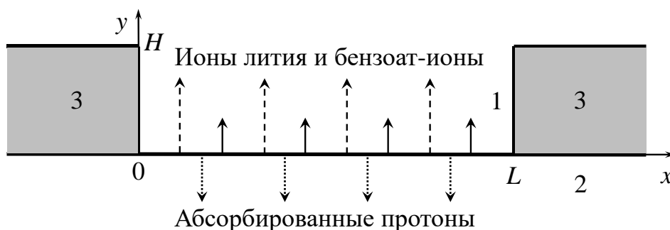
Рис. 1. Геометрия задачи. Система координат. 1 – расплав бензойной кислоты, 2 – кристалл ниобата лития, 3 – фотолитографическая маска
