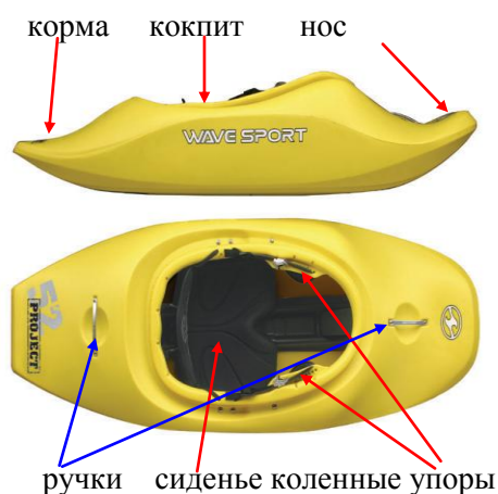
Рис. 9.31. Каяк: а – конструкция, б – на воде
