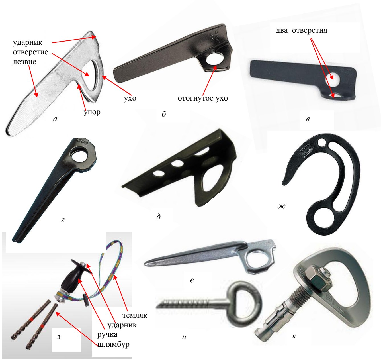
Рис. 10.25. Скальный крюк: а – вертикальный, б – горизонтальный, в – универсальный, г – V-образный, д – швеллерный, е – Т-образный, ж – изогнутый, з – шлямбуры с ударной ручкой, и – шлямбурный, к – самораспирающийся
