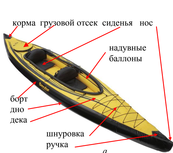
Рис. 9.25. Каркасно-надувная байдарка: а – двухместная, б – одноместная
