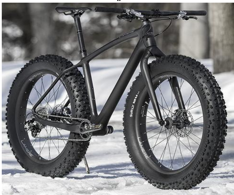
Рис. 14.6. Конструкция горного велосипеда: a – классического; б – фитбайка 1 – рама, 2 – верхняя труба рамы, 3 – рулевая колонка, 4 – вынос руля, 5 – руль с ручками, 6 – манетки (механизмы управления переключением передач) и тормозные ручки или моноблоки, 7 – рулевая (головная) труба рамы, 8 – вилка, 9 – колесо, 10 – шина, 11 – втулка, 12 – спицы, 13 – обод колеса, 14 – нижняя труба рамы, 15 – педаль, 16 – шатун, 17 – ведущие звезды, 18 – каретка, 19 – цепь, 20 – передний переключатель передач, 21 – задний переключатель передач, 22 – рамка натяжителя цепи с роликами заднего переключателя передач, 23 – крепление заднего переключателя к раме, 24 – кассета, 25 – задний треугольник рамы, 26 – ободной тормоз, 27 – подседельная труба рамы, 28 – седло, 29 – подседельный штырь, 30 – зажим регулировки седла по высоте
