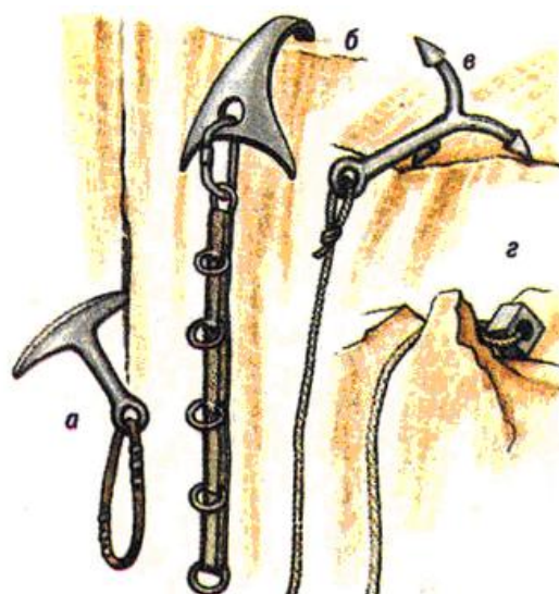
Рис. 10.27. Искусственные точки опоры на неровных скальных поверхностях: а – якорь, б – скай-хук, в – кошка, г – гекса
