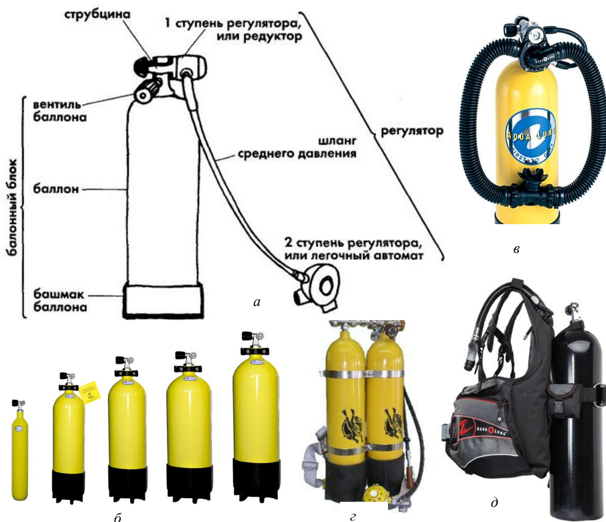
Рис. 11.11. а – конструкция акваланга, б – линейка баллонов для акваланга; внешний вид акваланга: в – однобаллонного, г – двухбаллонного, д – компенсатора плавучести
