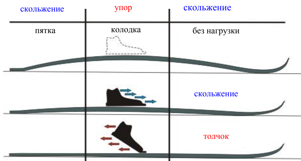
Рис. 12.5. Весовой прогиб лыжи при движении
