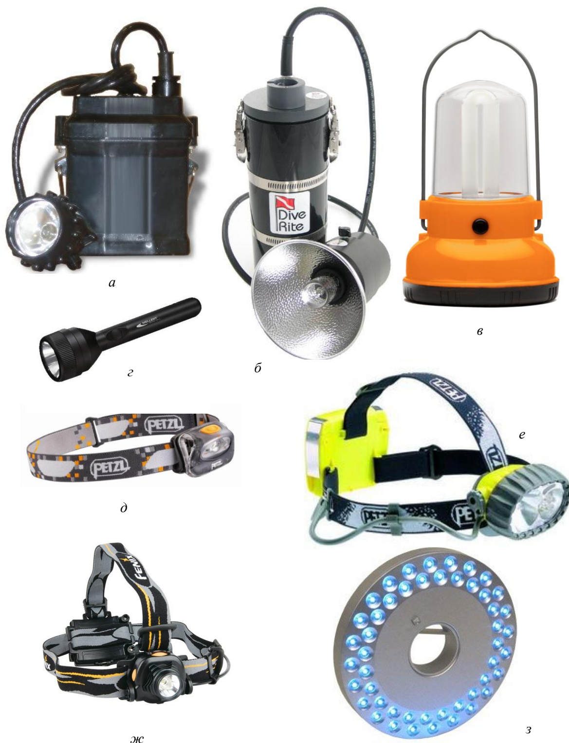
Рис. 11.5. Электрические фонари: а – шахтерский с лампами накаливания, б – с галогенной лампой, в – с люминесцентной лампой, г – ручной, д – налобный со светодиодами, е – налобный с галогенной лампой и светодиодами, ж – с одним мощным светодиодом, з – с набором светодиодов
