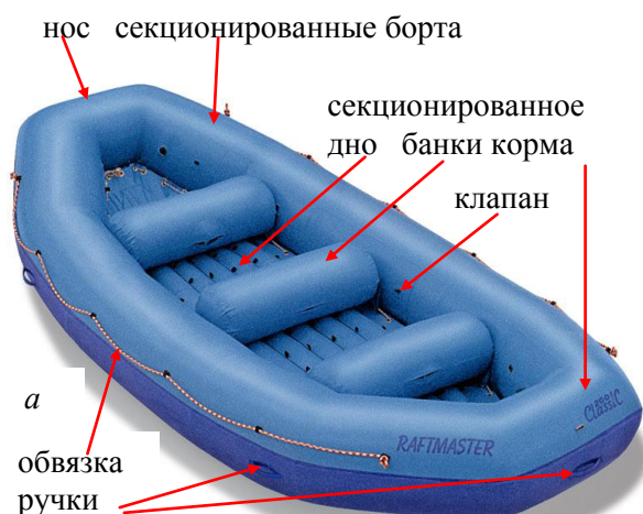
Рис. 9.36. Рафт: а – конструкция, б – прохождение порога
