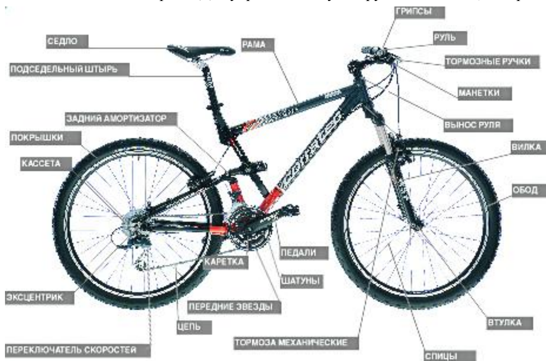
Рис. 14.10. Конструкция двухподвесного горного велосипеда
