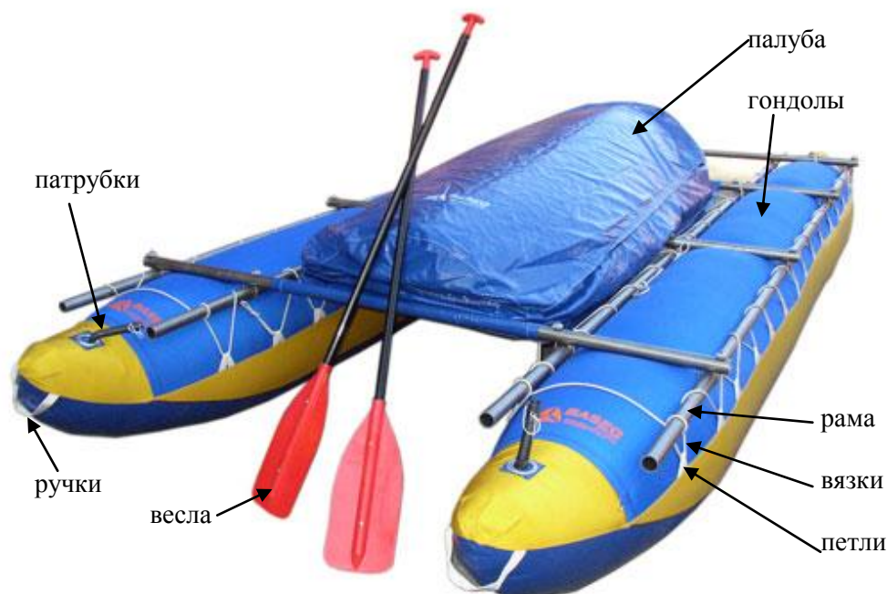
Рис. 9.15. Конструкция сплавного катамарана
