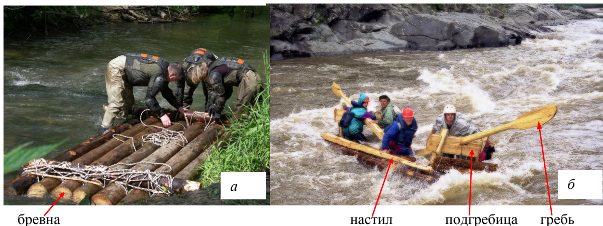
Рис. 9.34. Деревянный плот: а – сборка, б – прохождение порога
