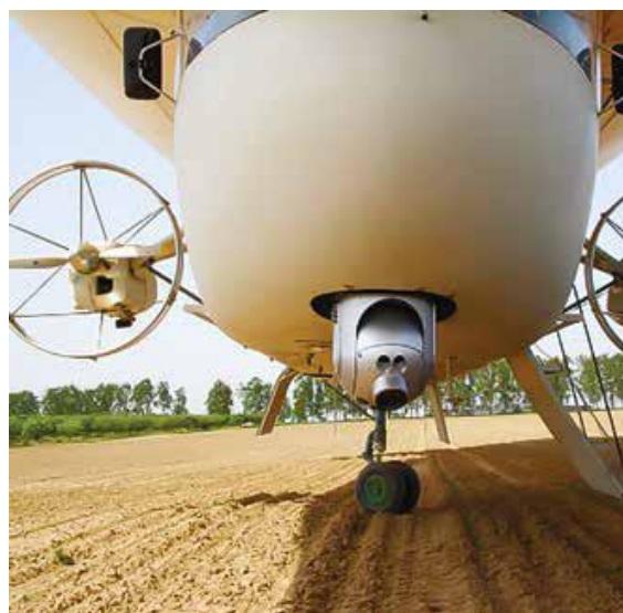
Рис. 5. Оборудование для проведения детальной съемки [3]
