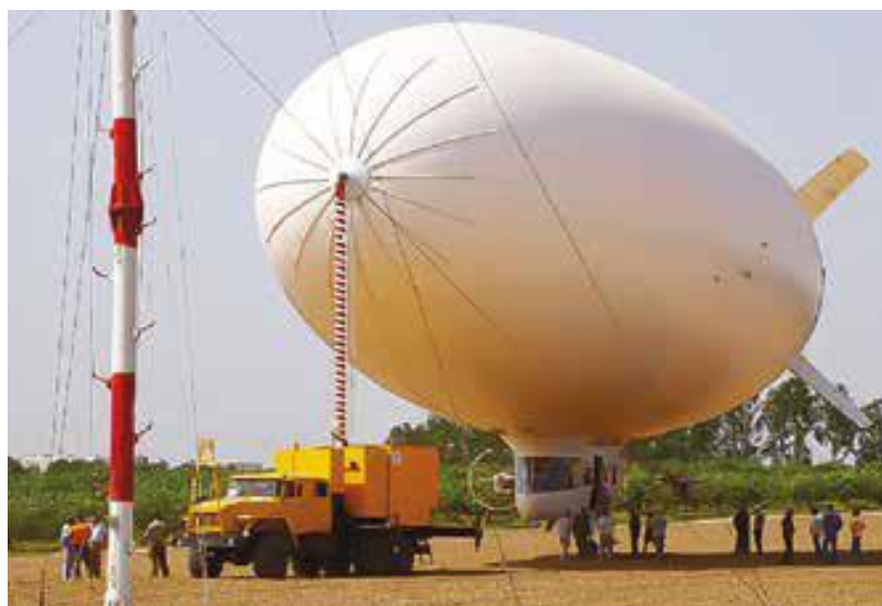
Рис. 6. Мобильная причально-мачтовая система [3]
