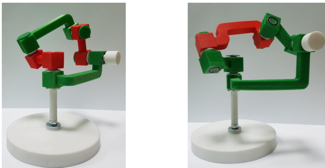
Рис. 4. Лабораторные модели пространственных 4R механизмов
