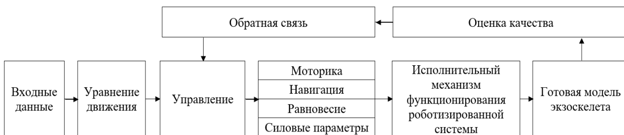
Рис. Схема комбинированного управления моделями экзоскелетов
