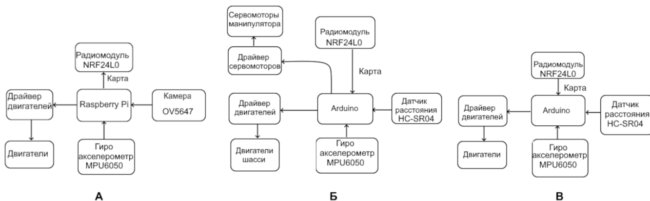
Рис. 2. Функциональные электрические схемы прототипов: А) Робот-поисковик; Б) Робот-доставщик и робот-курьер; В) Робот-сборщик
