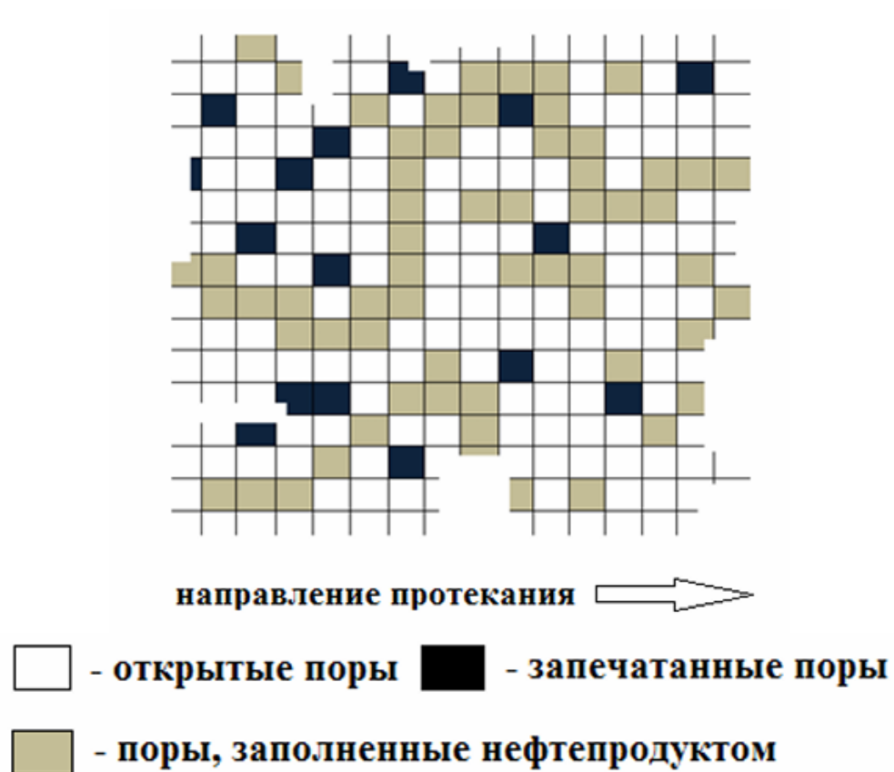
Рис. 52. Пористая структура в виде двумерной решетки, в которой появляется один проводящий кластер через открытые поры в направлении протекания [63]
