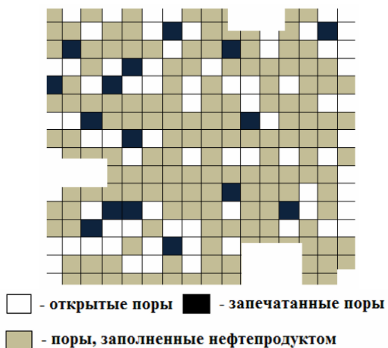
Рис. 53. Пористая структура в виде двумерной решетки, в которой формируется соединяющий кластер [63]
