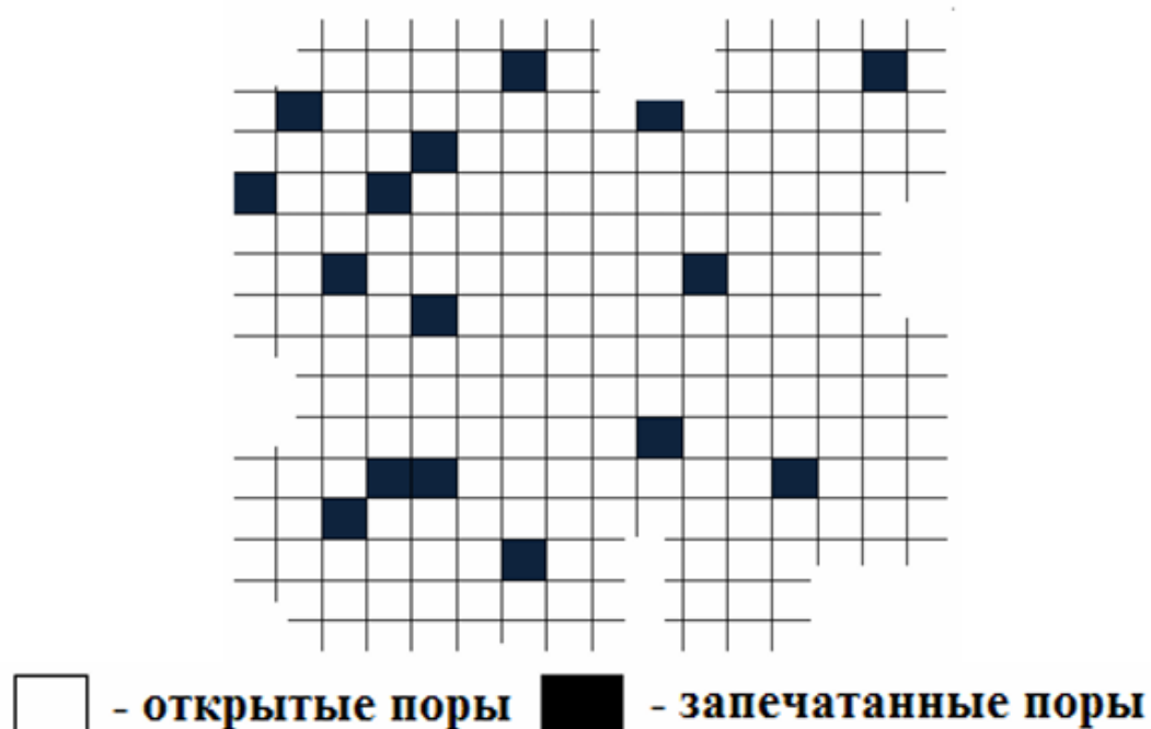
Рис. 50. Пористая структура в виде двумерной решетки, состоящая из открытых и закрытых пор [63]
