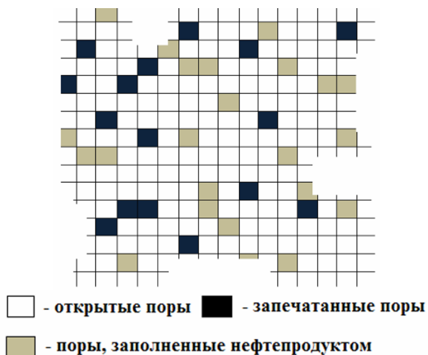
Рис. 51. Пористая структура в виде двумерной решетки, в которой часть открытых пор занята нефтепродуктом [63]
