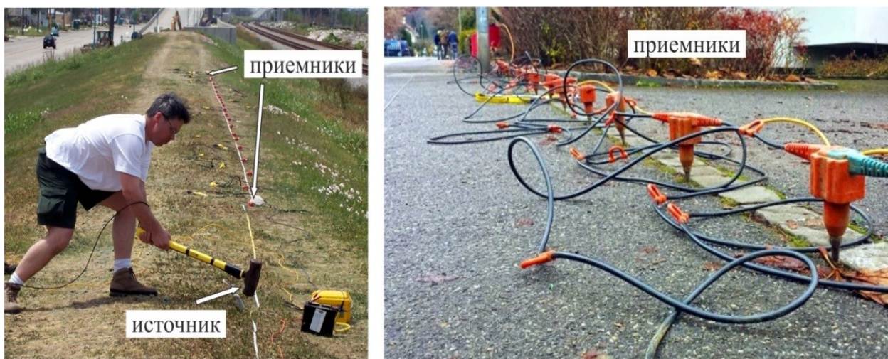
Рис. 3.17. Выполнение натуральных сейсмических измерений поверхностным бесконтактным способом Б
