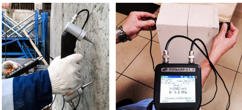
Рис. 3.12. Выполнение натурных ультразвуковых измерений одноканальными установками
