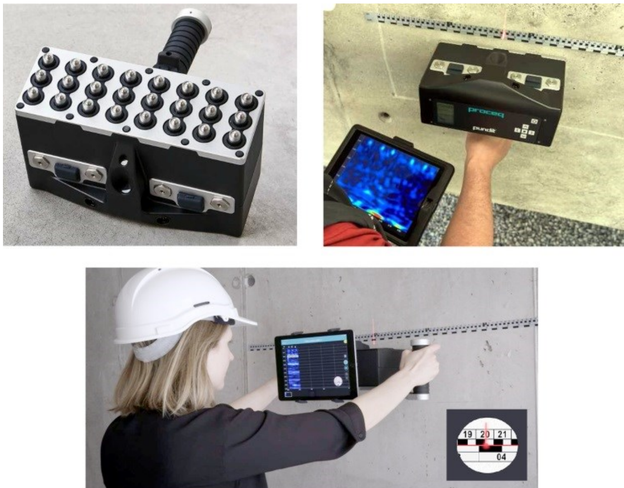
Рис. 3.13. Выполнение натурных измерений многоканальными ультразвуковыми сканерами
