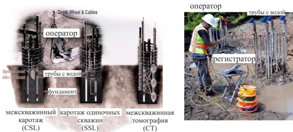
Рис. 3.23. Модификации внутренних исследований и пример полевого выполнения работ
