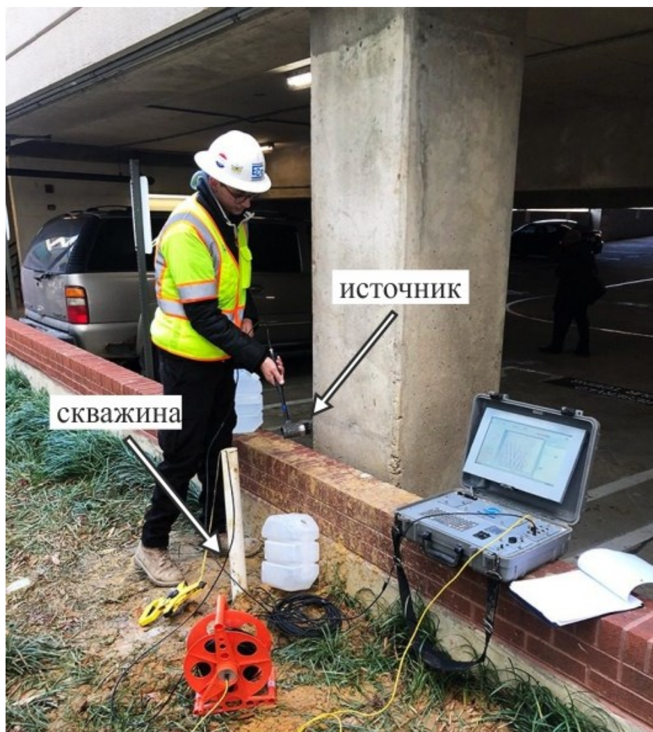
Рис. 3.20. Выполнение натурных измерений способом PS
