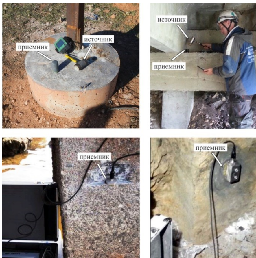
Рис. 3.3. Выполнение натуральных сейсмоакустических измерений поверхностным контактным способом А (Улыбин А. В. и др.)
